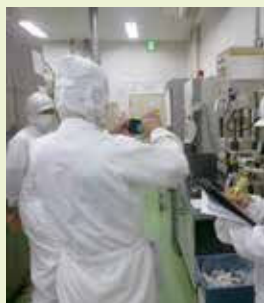
◀ サーモカメラで設備の温度分布を測定
